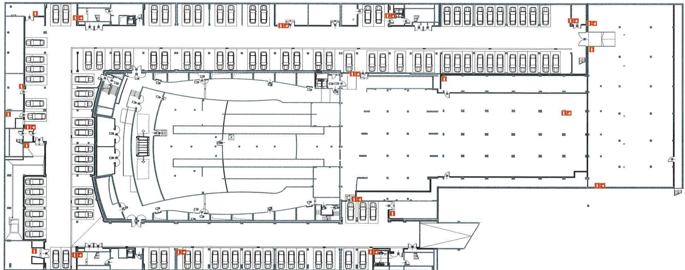
Plan rozmieszczenia gaśnic i hydrantów — kondygnacja: -1
